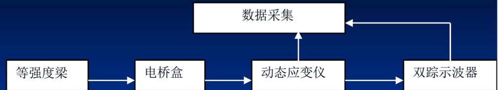
图4-34 动应力测量图
