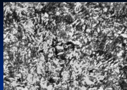
图6—31 45钢经淬火及200℃回火后的显微组织（400×）
