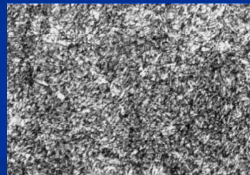
图6—32 45钢经淬火及400℃回火后的显微组织（400×）
