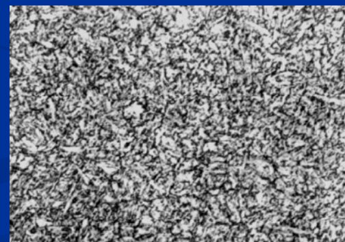
图6—33 45钢经淬火及600℃回火后的显微组织（400×）
